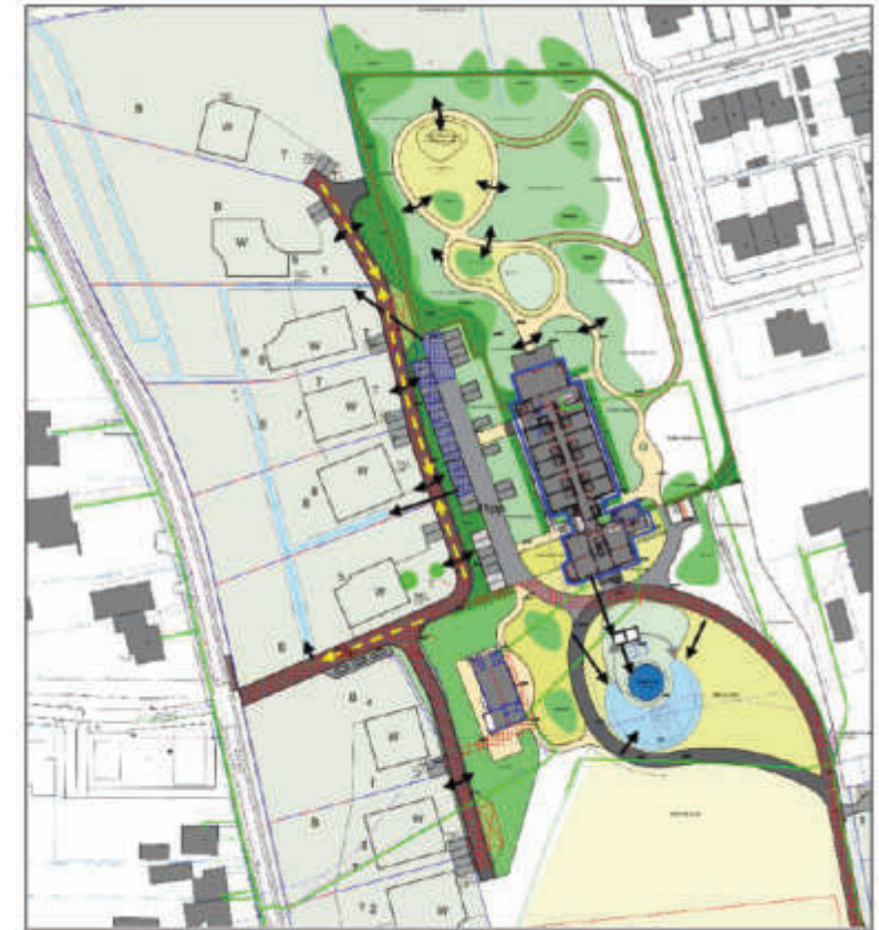
Figuur 1 Voorstel uitwerking watersysteem, de blauw gearceerde delen in het westen zijn de voorgestelde locaties met waterbergende wegfundering.
