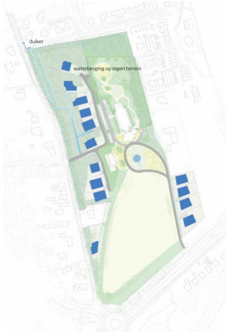
Figuur 1 Voorstel uitwerking watersysteem, de blauw gearceerde delen in het westen zijn de voorgestelde locaties met waterbergende wegfundering.
